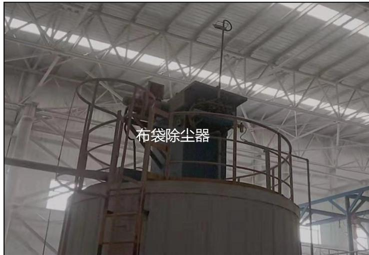
图 4.1-7 仓顶除尘器（部分）
